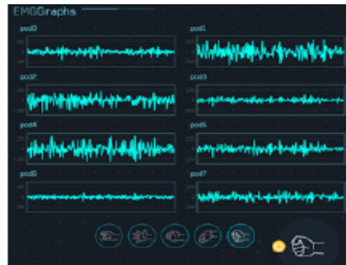
Figura 24. Señales tomadas del puño e indicadores mostrando la acción en prótesis a través de http://diagnostics.myo.com/
