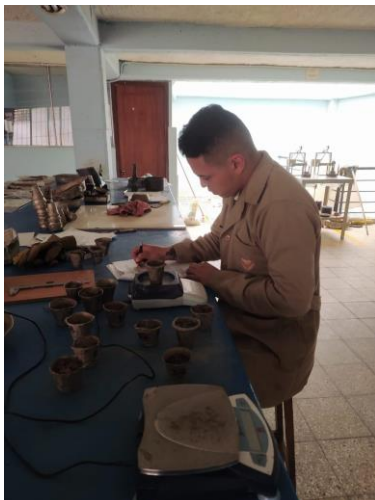
Figura 8. Realización de ensayo de LL.
