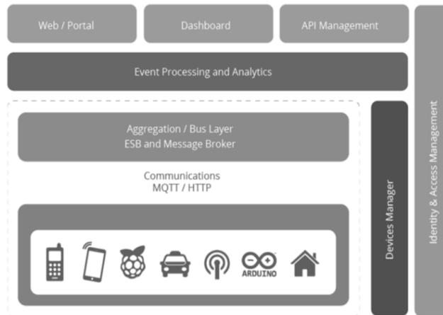
**Figura 2.** Arquitectura de una plataforma IoT (Fuente: [12])
