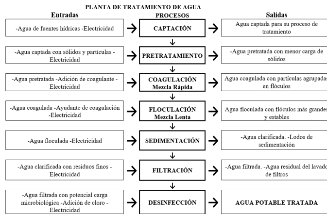
Figura 2: Mapa del proceso de potabilización en las plantas de tratamiento de agua potable.
