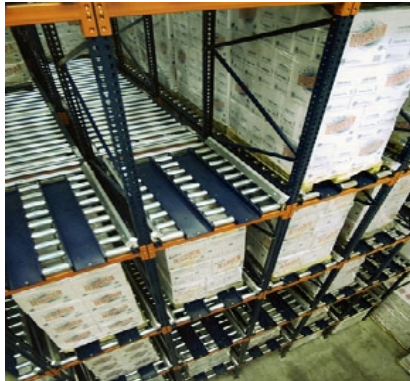
Ilustración 97. Dynamic paletization by gravity / paletización dinámica por gravedad.
